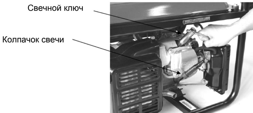
4. Произвести внешний осмотр свечи. В случае обнаружения трещин в изоляторе свечу следует заменить. Если свеча пригодна к дальнейшему использованию, ее нужно очистить проволочной щеткой.
