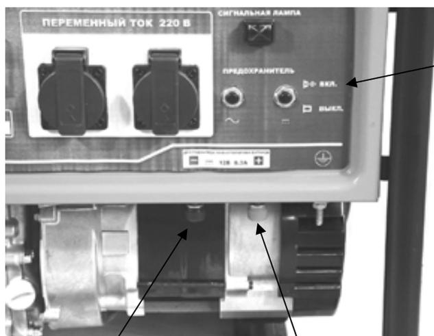
Предохранитель цепи постоянного тока
