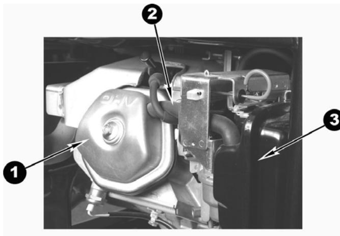
При повышении температуры выше -15°С, вынуть пробку из резиновой трубки 2 и вставить трубку в отверстие крышки клапанной коробки 1.
