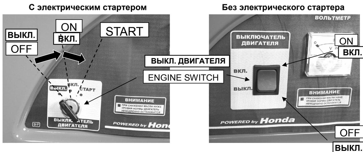
После пуска ключ возвращается из положения **СТАРТ** в положение **ВКЛ.** Непрерывная работа стартера не должна превышать 5 секунд. Если двигатель не удалось запустить, нужно отпустить выключатель и подождать не менее 10 секунд, прежде чем повторить пуск.
