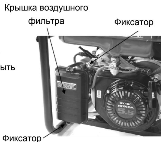
3. Пропитать элемент чистым моторным маслом, излишки масла отжать. Если на элементе останется слишком много масла, то в течение некоторого времени после запуска от двигателя будет идти дым.
