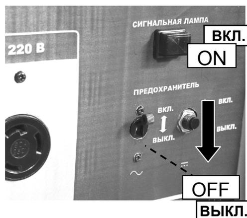
2. Отсоединить все кабели от розеток генератора. Отсоединить кабели от выходных клемм постоянного тока.
